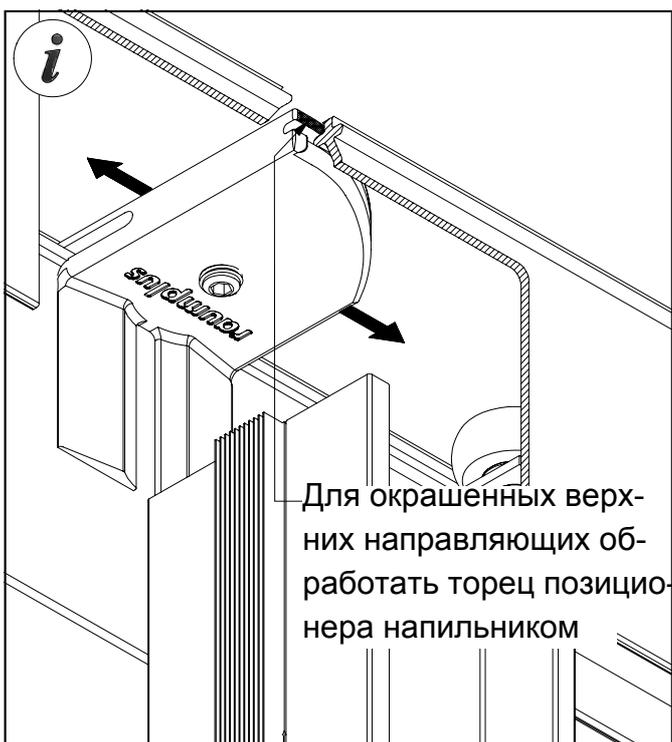
8\_ Обработайте торец позиционера напильником, чтобы откорректировать его размер под ширину направляющей
