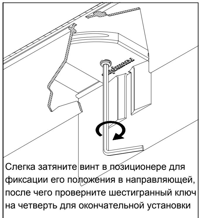
5\_ Фиксация позиционера в верхней направляющей с помощью винта с гайкой
